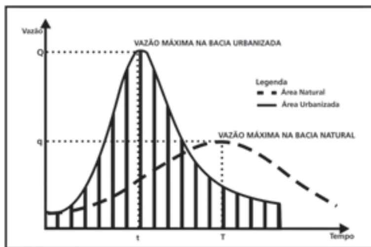
Figura 5.10 - Modificações no hidrograma pela impermeabilização da bacia
