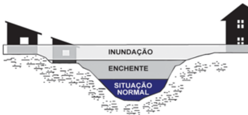
Figura 5.3 – Perfil esquemático do processo de enchente e inundação.
