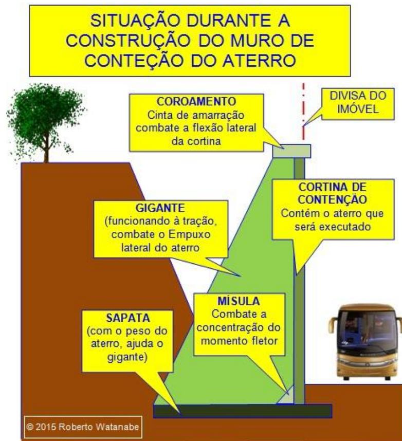
Na situação seguinte o espaço é preenchido com terra, é aterrado. Veja os esforços atuantes no muro de contenção e os componentes resistentes:
