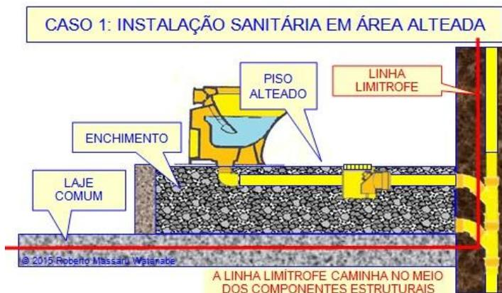
Divisa SEGURA, propicia isolamento acústico, térmico, visual e hídrico (se ocorrer um vazamento, a água será drenada pelo ralo de drenagem do enchimento e não passará para o apartamento de baixo).
